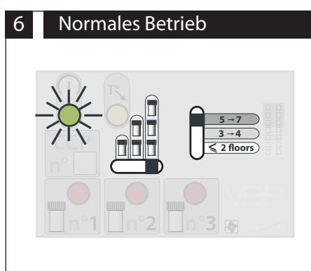
Grünes LED: langsames Blinken. Es bedeutet dass alles richtig funktioniert. Danach das Gehäuse mit Schlüssel und Griff schliessen.
