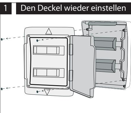
Den Deckel mit den 4 gelieferten Schrauben befestigen.
